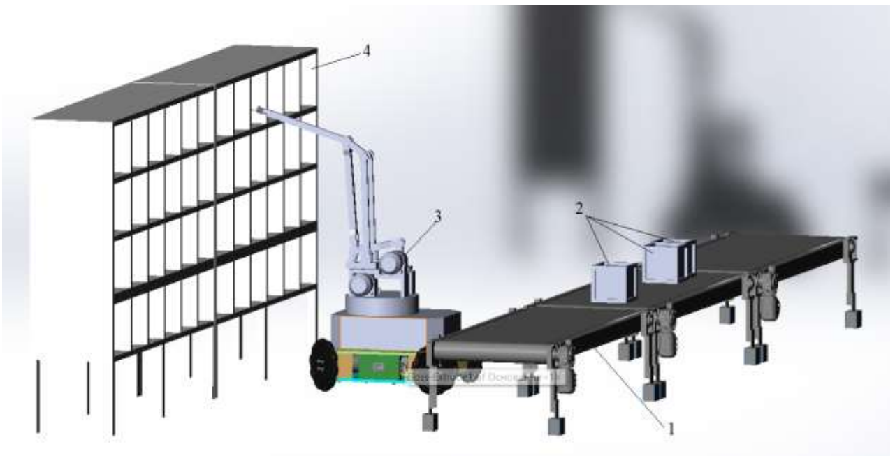
1 – конвейер желісі, 2 – сұрыптау және сақтау объектілері, 3 – сақтау және сұрыптауға арналған параллельді робот, 4 – сақтау шкафы.
